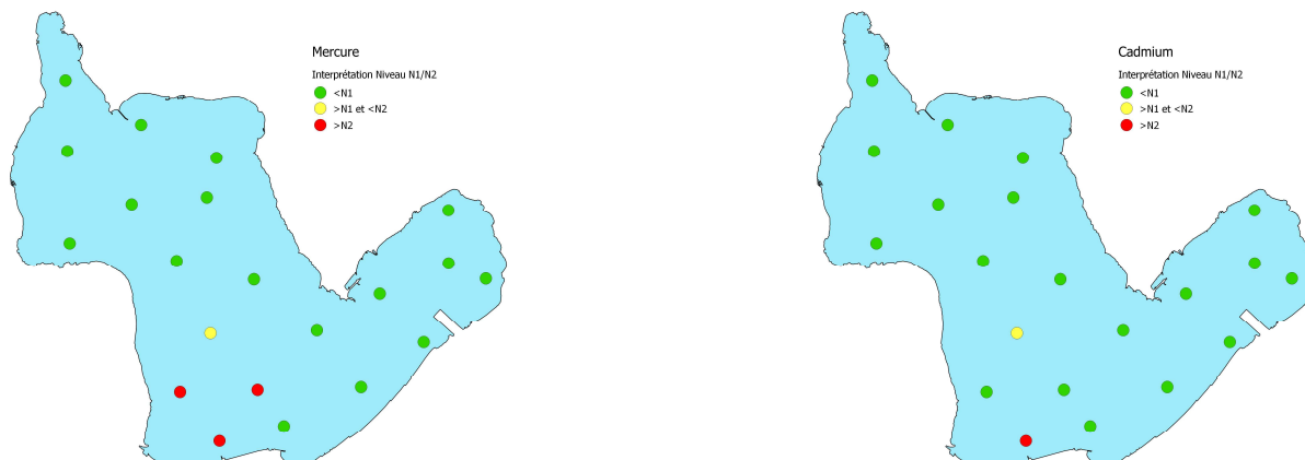
Figure 7 : Cartographie de l'état des concentrations en Mercure et Cadmium dans les sédiments de l'étang de Berre en 2016 selon les seuils N1/N2 réglementaires des autorisations de dragages.
