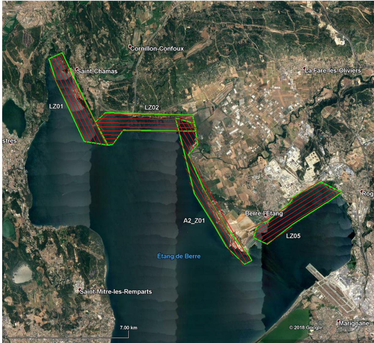
Figure 2 Polygones et lignes de vol du levé « Basse altitude »
