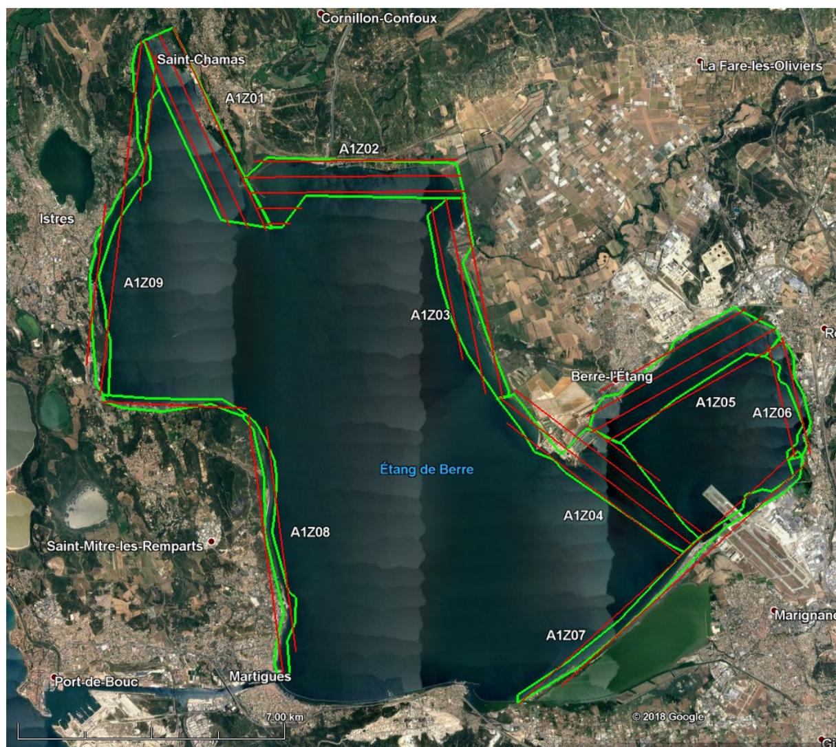
Figure 1 Polygones et lignes de vol du levé « Haute altitude »
