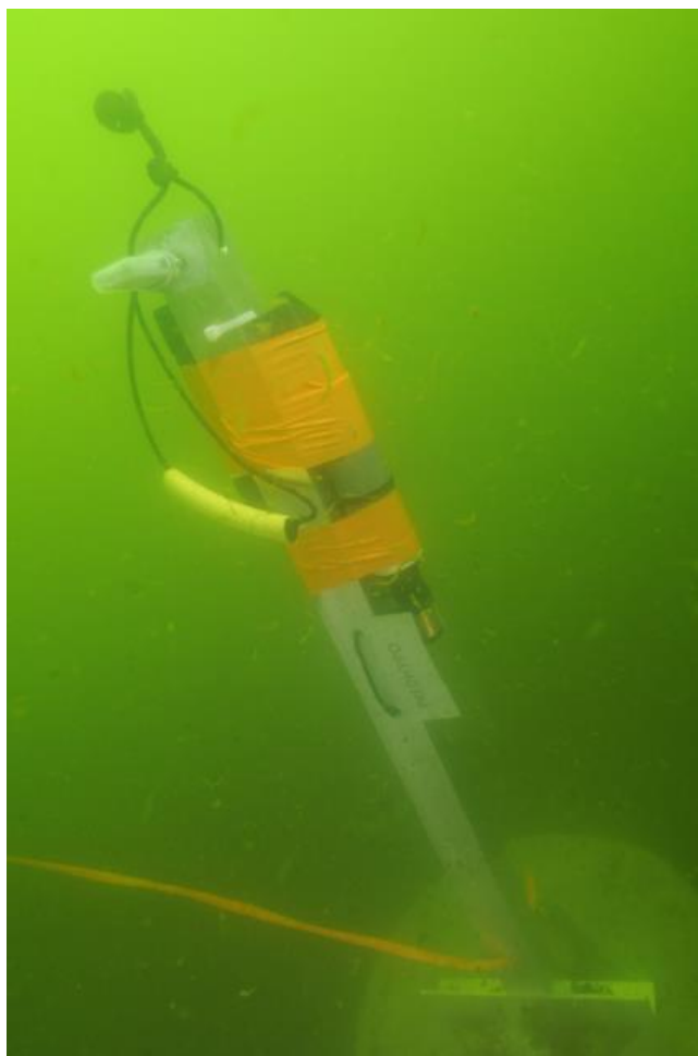
Figure 16 : Sondes de mesures PREDHYPO (température, salinité, oxygène)
