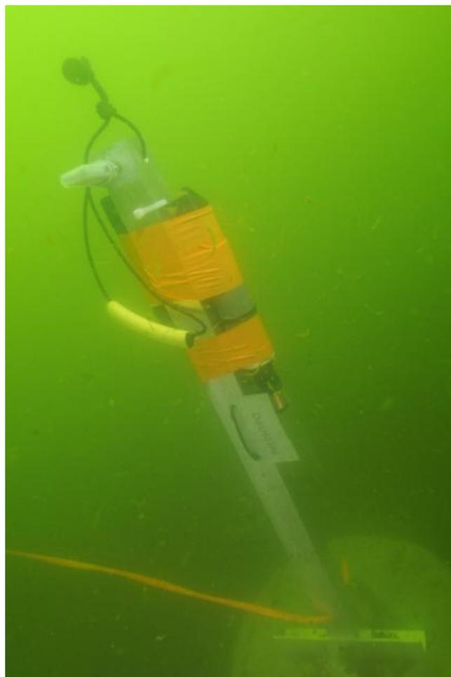
Sondes de mesures PREDHYPO (température, salinité, oxygène)
