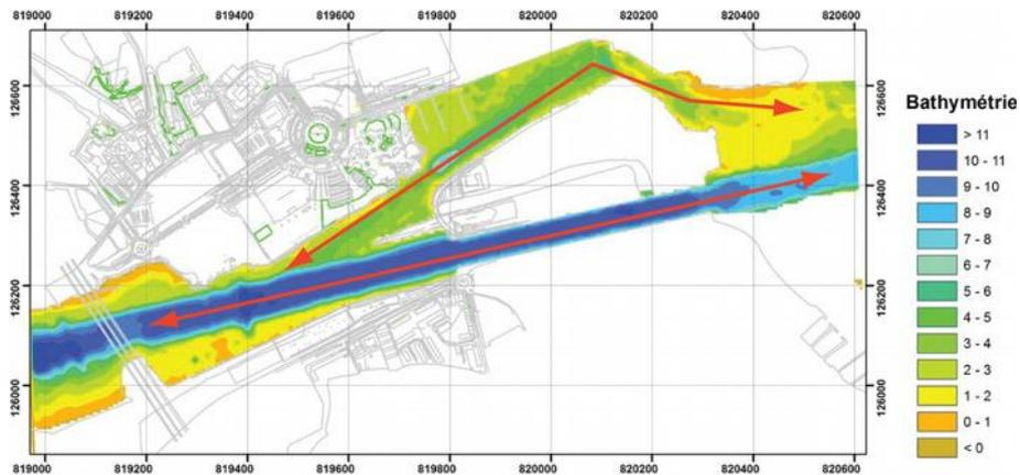
**Figure 2 2.** Bathymétrie du canal Caronte et du canal de Baussengue.
