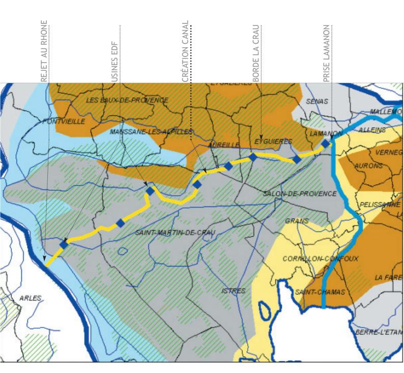
Cette solution n'a pas vraiment fait l'objet d'étude de variantes, son concept ayant émergé, en supplément au programme, lors de la première étape de l'étude phase II. Le principe en est de créer un canal de surface en utilisant la pente existante et en décomposant la chute à l'aide de plusieurs usines. Cette solution suit la logique générale de conception des aménagements hydroélectriques EDF en utilisant au maximum la topographie du terrain naturel.
